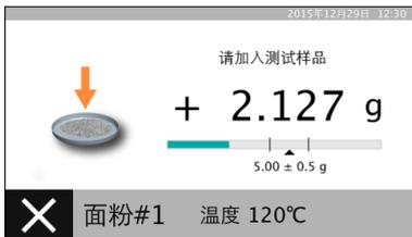
若您设置了初始重量, 界面将显示重量值标尺, 样品量不够, 重量值标尺显示蓝色:
