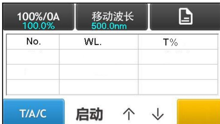
图 4-6 透射比测试数据列表界面
