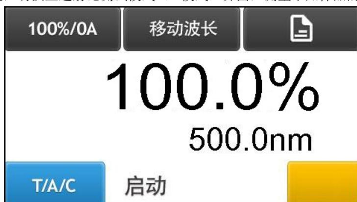
图 4-5 透射比测试模式界面
