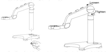
■ 旋紧旋钮到适当程度,可自由上下调节支架臂,支架臂会稳定在调节位置。独立电极支架底座的两个小孔可用于放置电极保护瓶 (如图)
