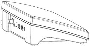
对于二合一 pH 电极只需要将 BNC 母头旋到 pH 接口(BNC 公头)上。 三合一 pH 电极 pH 接口和温度接口都要连接。独立温度电极可接到温度接口。 Mini-Din 接口用于电导电极的的连接。数据接口可经连接线连接打印机。
