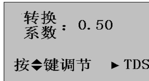
按“▲”或“▼”键修改到需要的转换系数，按“确认”键，仪器保存设置的转换系数值，并返回测量状态。
