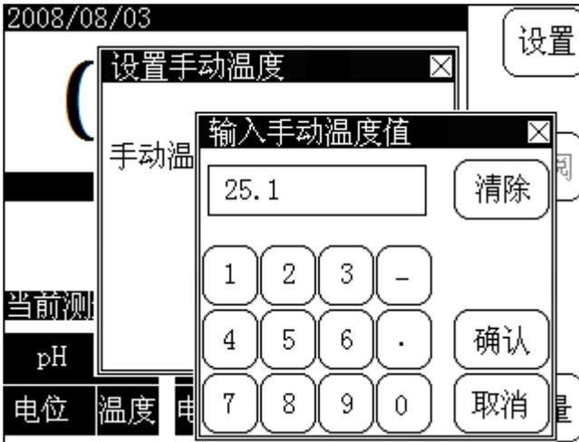
设置手动温度输入显示示意图
