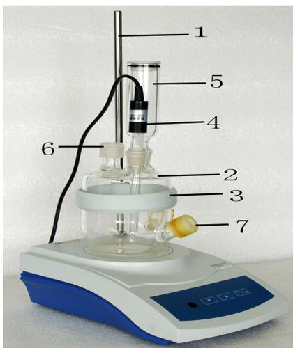
◆将固定架支撑杆（1）旋入搅拌器，将溶液杯（2）放置搅拌器上，将溶液杯固定架（3）套入固定架支撑杆（1）并固定好溶液杯（2）；
