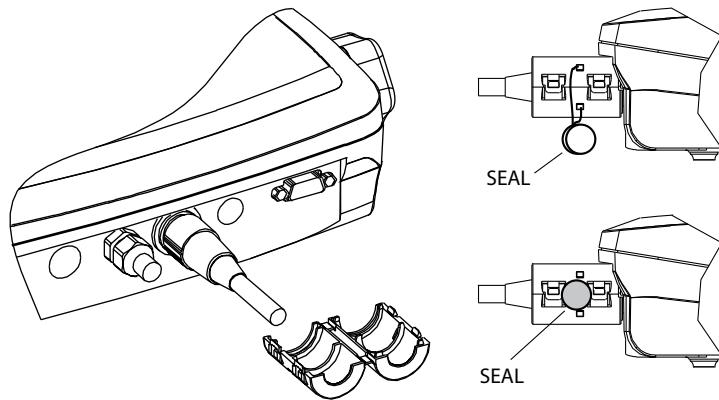
Figure 6-5. 传感器铅封套圈
