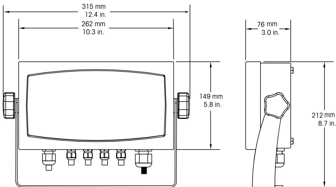
Figure 8-2. T51XWZH 电子称重仪表外形尺寸.
