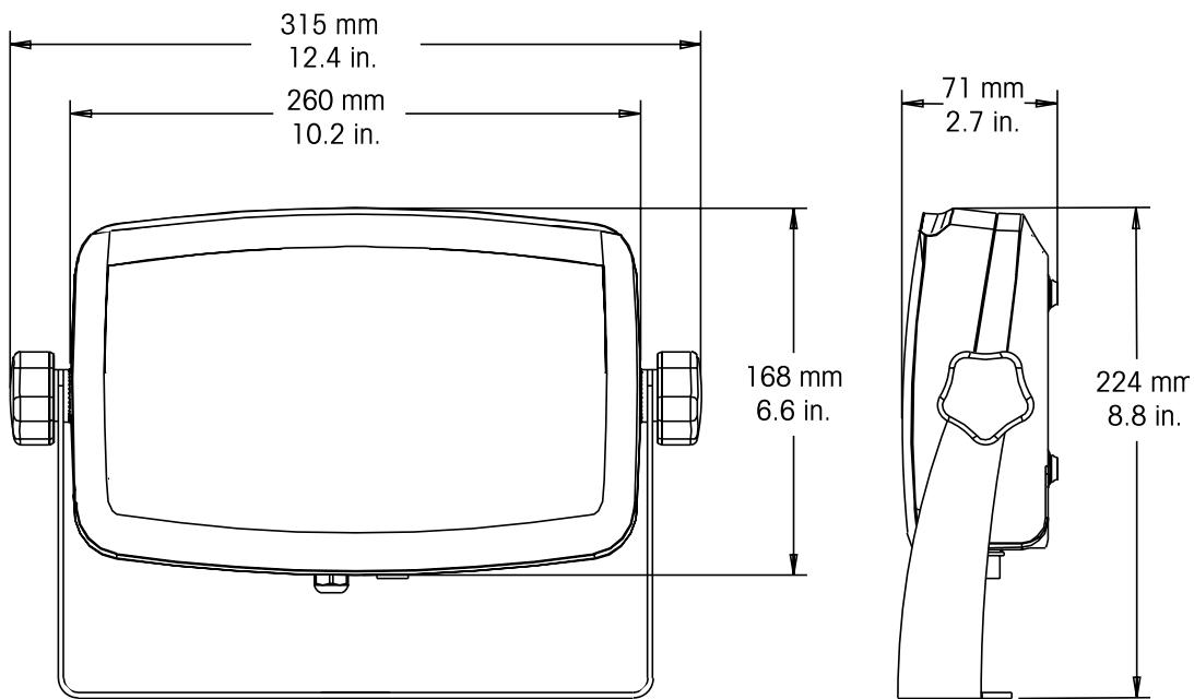
Figure 8-1. T51PZH 电子称重仪表外形尺寸.
