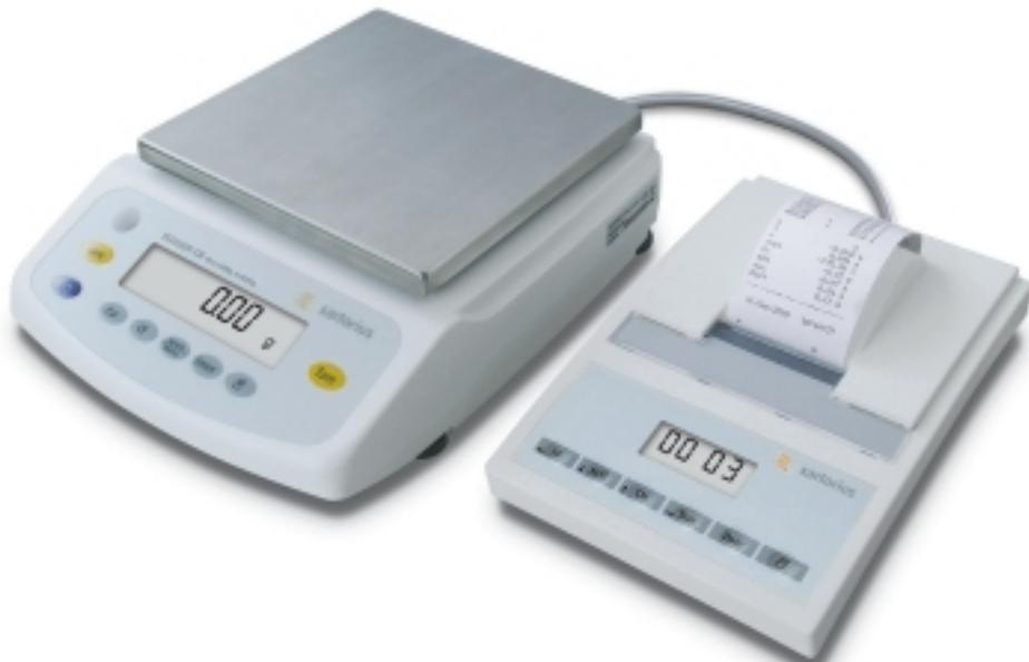
如果要得到符合 ISO/GLP 标准的原始或校准 / 调整数据，只需接 YDP20-OCE 数据打印机，然后按下打印键即可。
