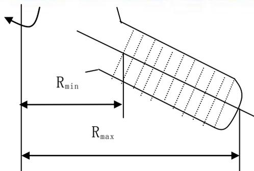
图 1 离心时试管状态示意图
