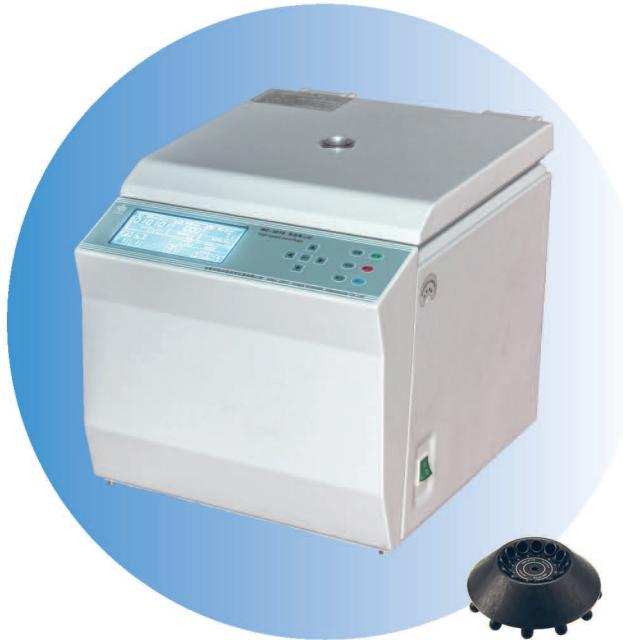
LC-10C 台式结构,调速系统采用交流变频调速,微电脑控制转速和离心时间,触摸式按键设定工作参数,LCD 显示离心时间、转速和离心力,配有电子门锁,是血站(库)、输血科等实验场所必配的设备。
