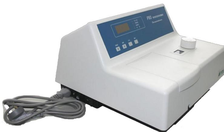
如上图所示，将随机附件中的主机电源电缆一端插入仪器 220V 市电输入插座，另一端插入外部 220V 市电输出插座即可。
