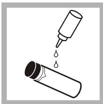
6. 試料セルの上部から底部まで少量のシリコーンオイルを塗布します。
