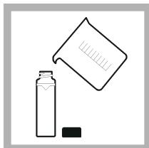
4. Rincez une cuve d'échantillon propre et vide deux fois avec la solution à mesurer et videz-la. Remplissez jusqu'au trait (environ 30 ml) avec l'échantillon et placez immédiatement le bouchon sur la cuve pour échantillon.
