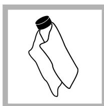
**5.** Limpe as células da amostra com um pano macio, que não solte fios para remover manchas de água e impressões digitais.
