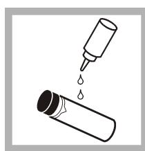
8. 从试样瓶顶部滴入一小滴硅油, 使之从顶部到底部。
