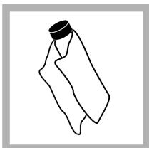
7. 使用随附的油布将硅油均匀地涂抹在试样容器表面。擦掉多余的油。确保试样容器至几乎全干的状态。
