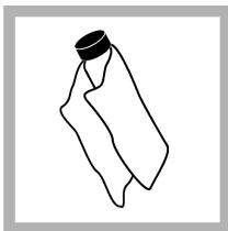
7. 付属のオイルクロスを使用して、試料セルの表面にオイルを均等に塗布します。余分なオイルを取り除きます。試料セルがほとんど乾燥していることを確認します。
