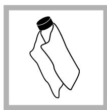
9. 使用油布将硅油均匀地涂抹在试样瓶表面。去除大部分油。确保试样瓶处于几乎全干的状态。
