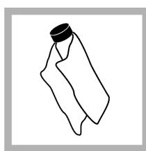
7. 取获显示屏上显示的 StabICal 标准溶液。用柔软的无绒布清洁试样瓶, 清除水渍和指纹。
