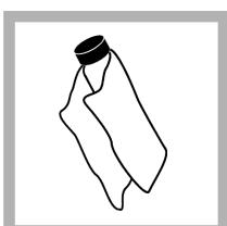
7. Utilisez le chiffon de huilage fourni pour appliquer l'huile uniformément sur la surface des cuves. Retirez l'excès d'huile. Vérifiez que les cuves sont presque sèches.
