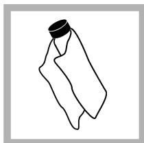
**9.** Use o pano de lubrificação para aplicar o óleo igualmente à superfície do frasco. Remova a maioria do óleo. Certifique-se de que o frasco esteja quase seco.
