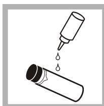
**5.** 从试样瓶顶部滴入一小滴硅油，使之从顶部流到底部。
