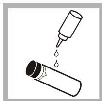
6. 从试样容器顶部滴入一小滴硅油，使之从顶部流到底部。
