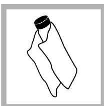
**6.** 使用油布将硅油均匀地涂抹在试样瓶表面。去除大部分油。确保试样瓶处于几乎全干的状态。
