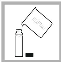
4. 汚れていない空の試料セルを測定する溶液で2回すいで排水します。試料をライン（約30 mL）まで充填し、すぐに試料セルにキャップを取り付けます。
