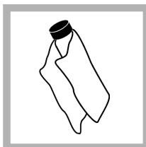
9. Utilice el paño lubricante para aplicar el aceite de forma uniforme por la superficie del vial. Retire la mayor parte del aceite. Asegúrese de que el vial esté casi seco.
