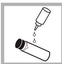
**6.** Aplique uma pequena gota de óleo de silicone desde a parte superior até a parte inferior das células da amostra.
