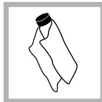
**4.** Limpe os frascos de Gelex com um pano macio, que não solte fiapos para remover manchas de água e impressões digitais.
