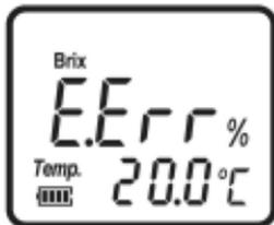
测量过程中，液池中的溶液量过少或者没有滴溶液
