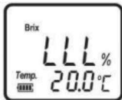
测量的溶液低于该机器
