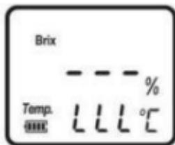
测量的溶液温度低于该机器的测量温度下限
