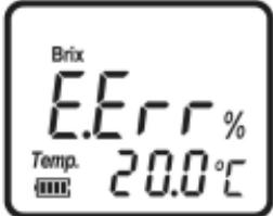
测量过程中，液池中的溶液量过少或者没有滴溶液
