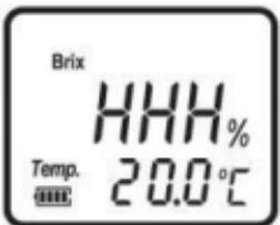
测量的溶液超出该机器的量程上限。
