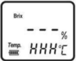
测量的溶液温度超出该机器的测量温度上限
