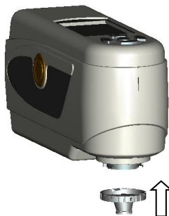
图 12 加长测量口径对准安装孔位
