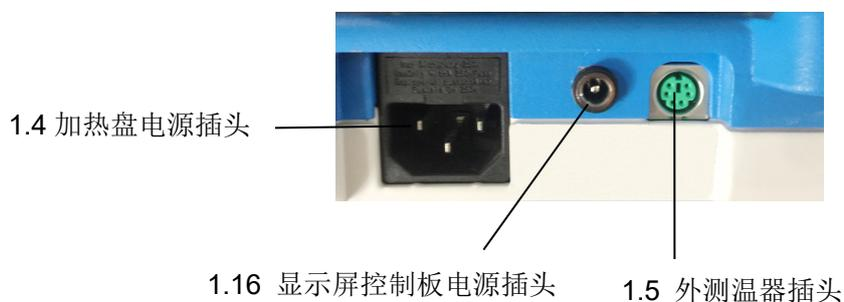
**注：使用仪器时，加热盘电源插头与显示屏控制板电源插头需同时连接电源。**
