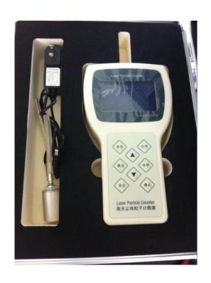
尘埃粒子计数器,可与 PC 电脑数据采集系统连接可进行远程控制,可直接观测仪器的测试情况,测试数据可通过电脑进行分析处理并可以保存为 Excel 文件。技术指标均满足国家计量总局颁布的 JJG547-88 检定规程的要求,整机功能采用美国微电脑控制处理技术及半导体激光传感器技术及进口气泵,具有功能多、测量精度高、速度快、便于携带和操作简单等特点。仪器一次采样可同时测得多种粒径的尘埃粒子数,该产品已被广泛应用于电子生产企业洁净室检测;过滤器现场检测、捡漏;可监测生物安全,HVAC 系统,计算机室,饮料包装环境,药品、医疗器械生产环境,医院洁净手术室,汽车喷涂环境,微电子、生化制品、食品卫生、精细化工、精密机械等生产和科研部门,是暖通空调和制药企业及其监督管理部门贯彻 GMP 规范和电子生产企业首选仪器。
