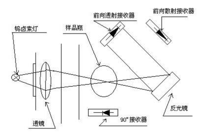
光通过透镜聚焦后照射到样品瓶上,一部分信号由 90°接收器接受,另外分别由前向透射接收器和前向散射接收器接收。
