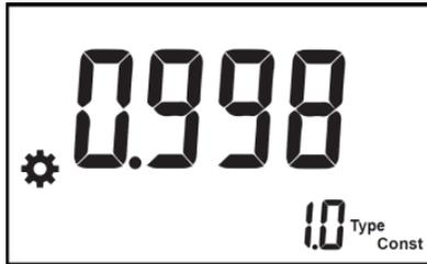
图 5-9 电极类型 1.0，电极常数 0.998 显示示意图
