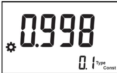
图 5-10 电极类型 0.1，电极常数 0.0998 显示示意图
