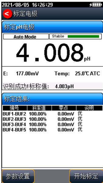
图 5-5 pH 电极标定示意图
