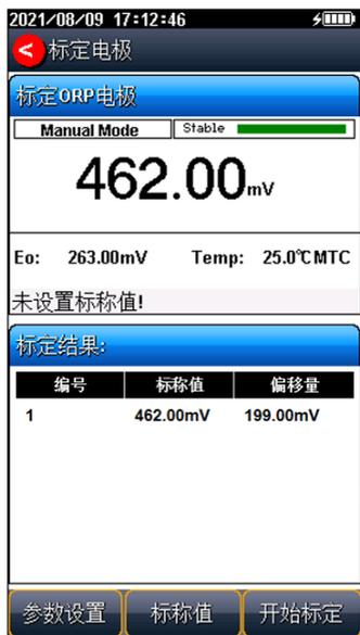
图 5-11 ORP 电极标定示意图
