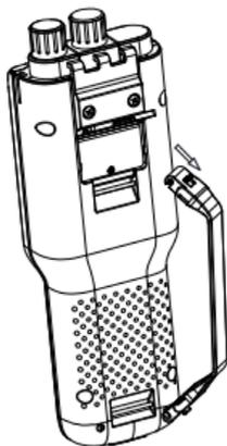
图 4-4 便携式腕带安装示意图
