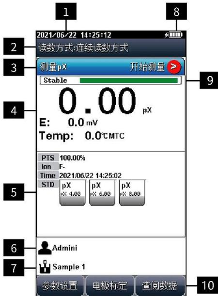
图 5-1 仪器显示屏幕示意图
