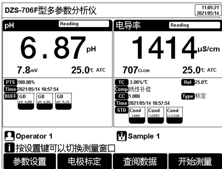
图 5-4 两参数显示界面示意图
