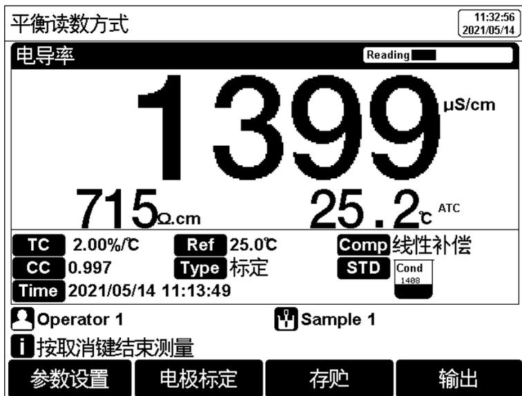
图 5-13 电导率测量（单通道测量模式）
