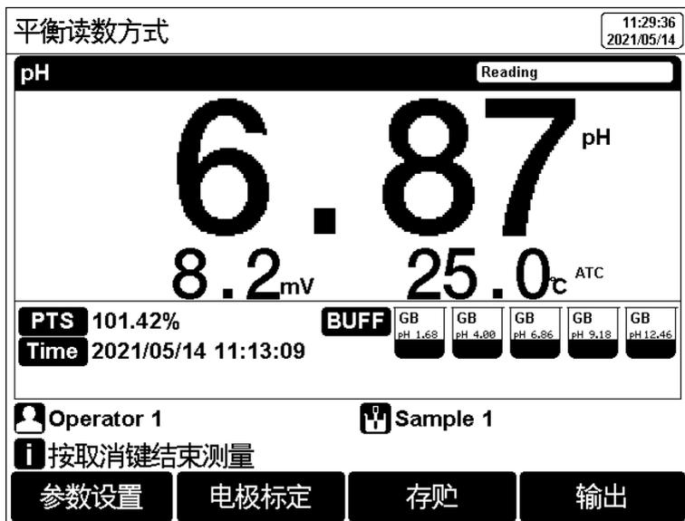
图 5-8 pH 测量（单通道测量模式）
