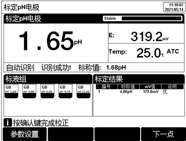
图 5-7 pH 电极标定
