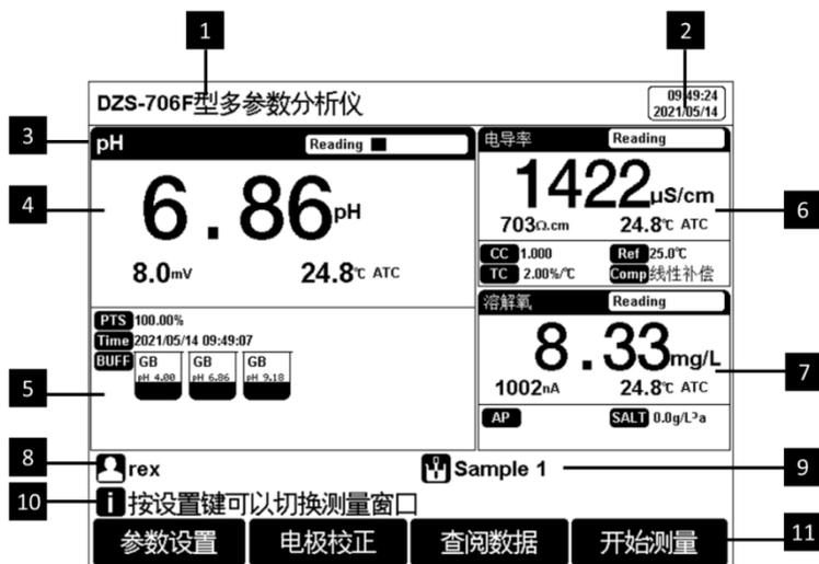
图 5-1 仪器显示屏幕示意图
