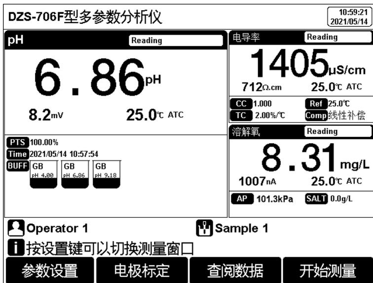
图 5-3 三参数显示界面示意图
