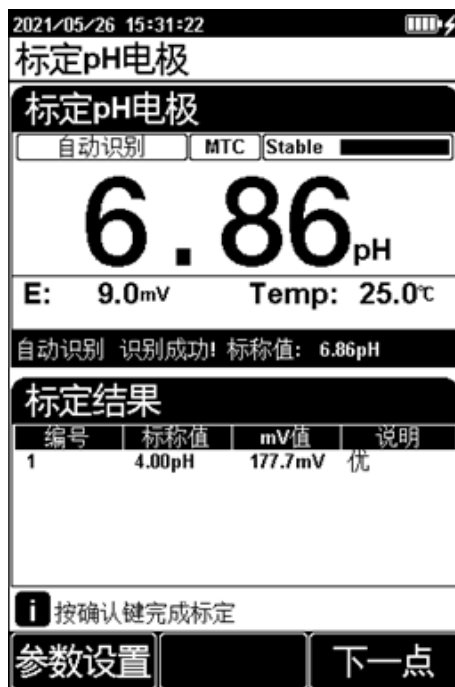
图 5-6 pH 电极标定示意图
