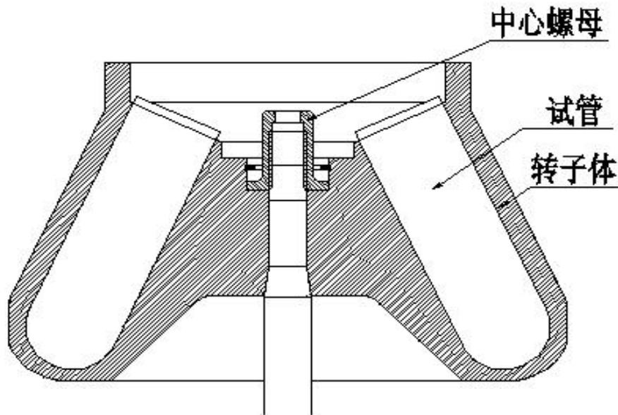
图 2 安装角转子
