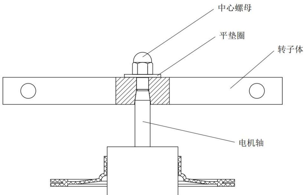
图3 安装水平转子
