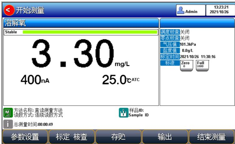
图 5-11 溶解氧测量（单通道测量模式）示意图
