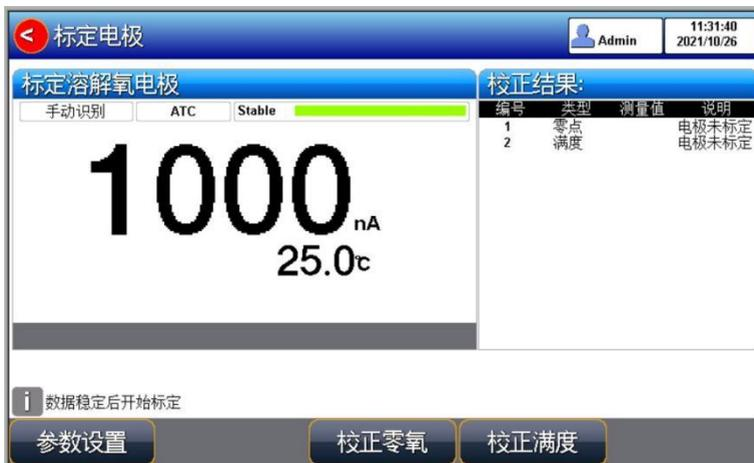
图 5-10 溶解氧标定示意图
