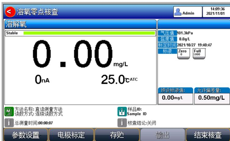
图 5-13 溶解氧零点核查示意图
