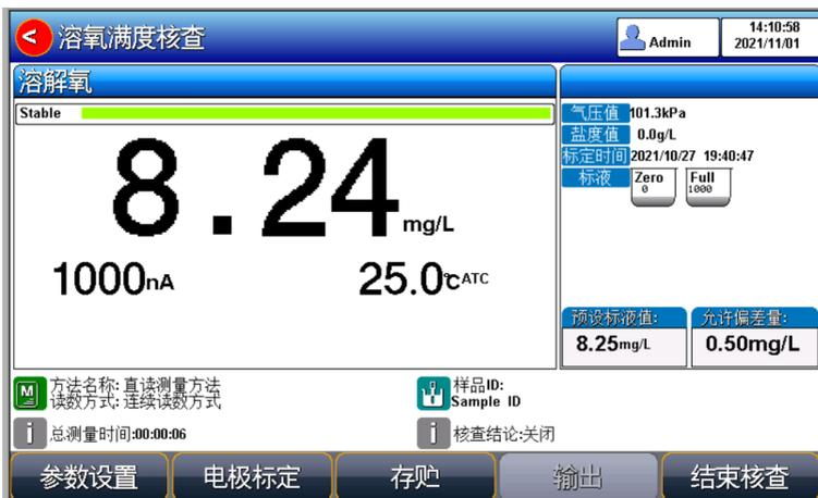
图 5-12 溶解氧满度核查示意图
