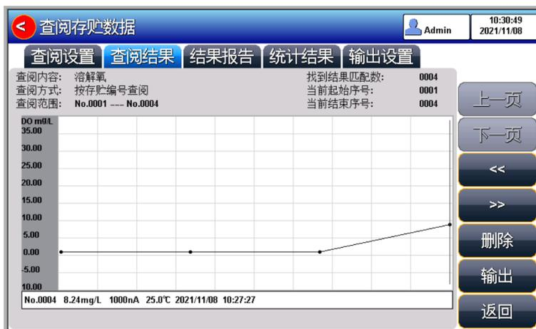
图 5-21 以图形形式显示检索到的存贮结果示意图
