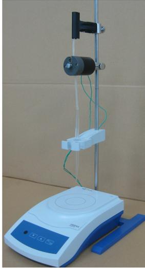
**搅拌器和测量装置示意图（图 2）**
