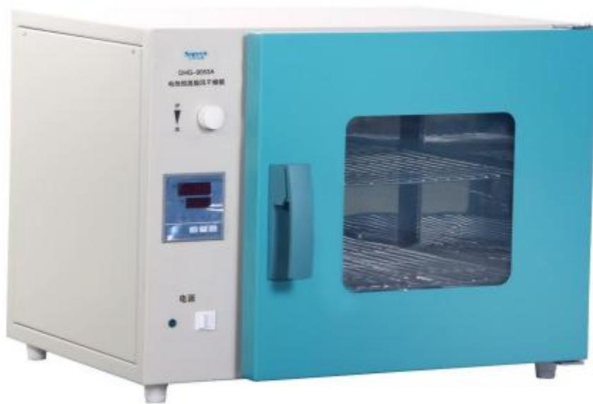
**数码管 台式 控温范围：RT+10 ~ 250°C 温度分辨率：0.1°C 容积：120L**
