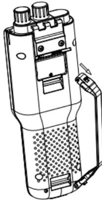
图 4-4 便携式腕带安装示意图
