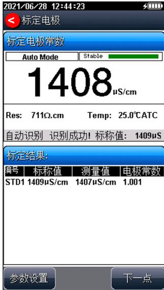
图 5-2 电极常数标定示意图
