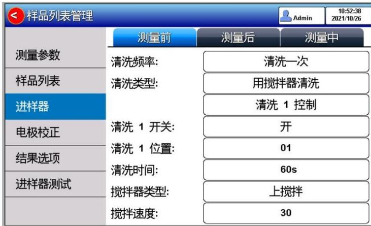
图 5-23 进样器设置示意图
