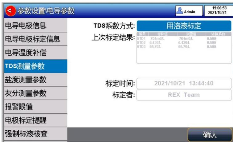
图 5-8 TDS 测量参数设置示意图
