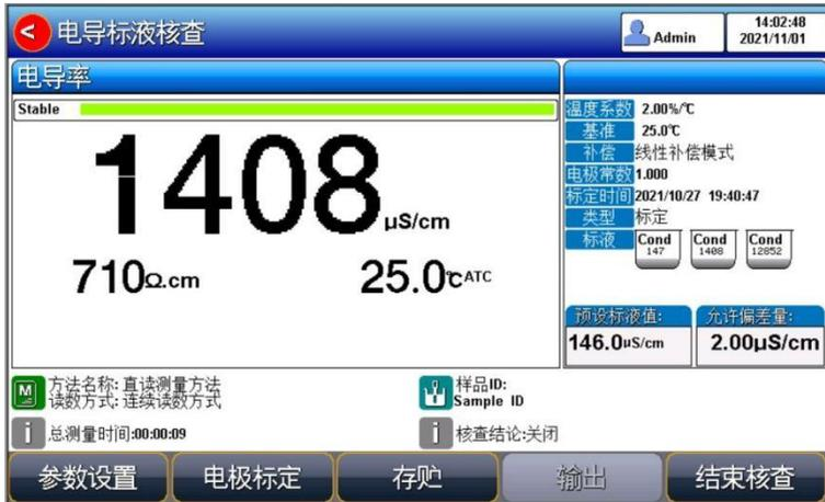
图 5-20 电导率标液核查示意图
