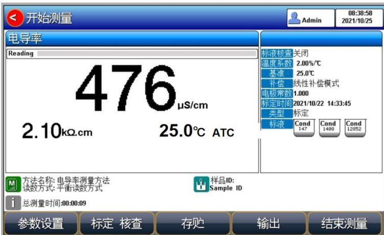
图 5-19 电导率测量（单通道测量模式）示意图
