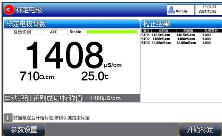
图 5-18 电极常数标定示意图
