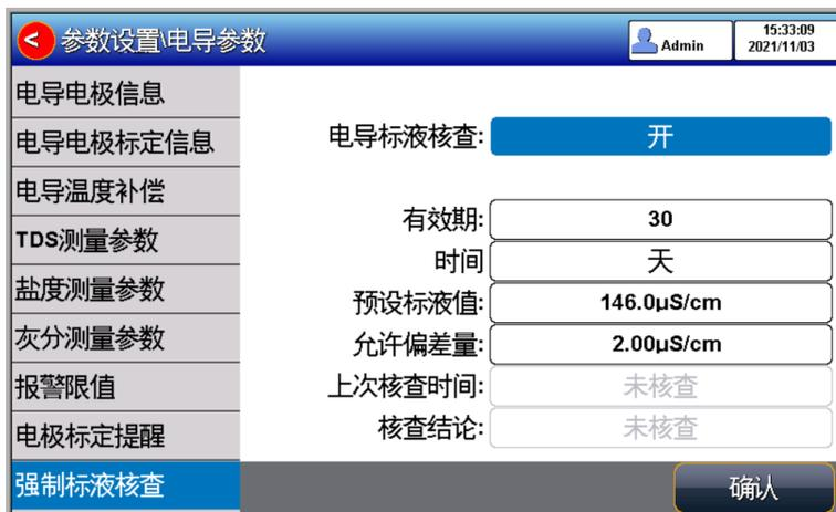
图 5-13 电导标液核查设置示意图
