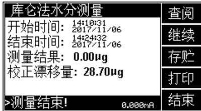
图 7-5 测量结束显示示意图
