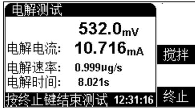
图 5-13 电解测试功能显示示意图
