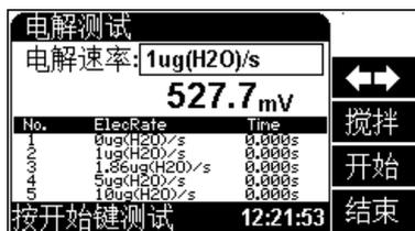
图 5-12 电解测试功能显示示意图
