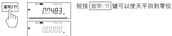
**注：**根据国家相关法规，初始置零效果大于最大称量的20%或置零效果大于最大称量的4%，该功能不能使用。
