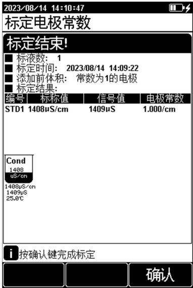
图 5-6 电极常数标定结果示意图
