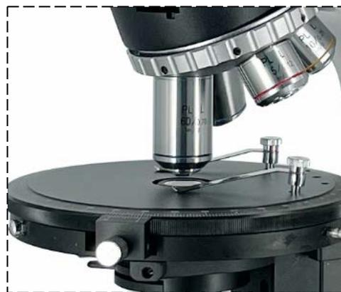
◆旋转圆工作台， $\Phi 150\text{mm}$
