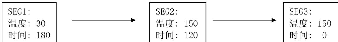
以上程序段代表工况从 30℃ 升到 150℃ 需要 180 分钟，工况温度第 1 段时间设置的越长，升温的速度越慢，满足有些物品做实验温度不能升得过快的要求，第 2 段代表 150℃ 恒温 2 小时，第 3 段时间设置为 0 代表第 2 段 2 小时运行完后，设备即停止运行。第 3 段运行结束段设置温度时需要注意，也需要设成和第 2 段的温度值一样。
