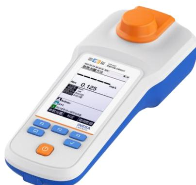
DGB-402F 型便携式余氯/总氯测定仪基于 DPD 比色法设计开发，可直接测量水中的余氯、总氯，使用方便，准确可靠。该方法符合水质分析领域测定相关指标的国家标准，被广泛应用于饮用水、景观水、医疗废水、游泳池水、消毒剂等样品中余氯、总氯的测定。
