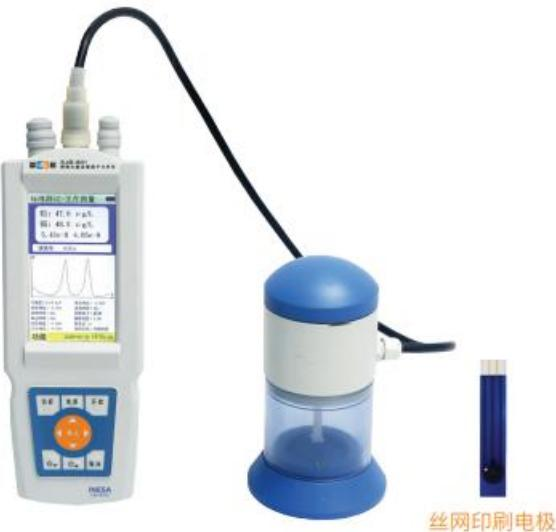
SJB-802型重金属快速检测仪，采用阳极溶出伏安法，既支持丝网印刷电极，又支持三电极测量，可应用于铅、镉、铜、砷、汞、锌、硒、锰、镍、铬等重金属的检测。该仪器拥有与原子吸收等大型仪器相近的检出限和检测灵敏度，具有设计新颖，体积小巧，操作简单，智能化程度高，误差小等特点。
