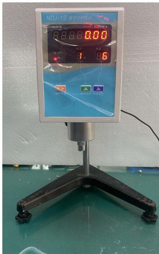
本仪器采用先进的机械设计、制造工艺和单片机控制技术，LED数码管显示，测量准确；本粘度计采用简洁的三个按键操作模式，一键选配转子号，一键调整转速，一键读取粘度值，使用极为方便。
