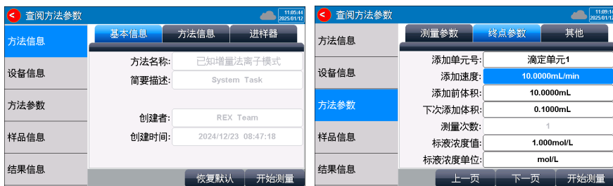
图 7-7 已知增量法参数显示示意图
