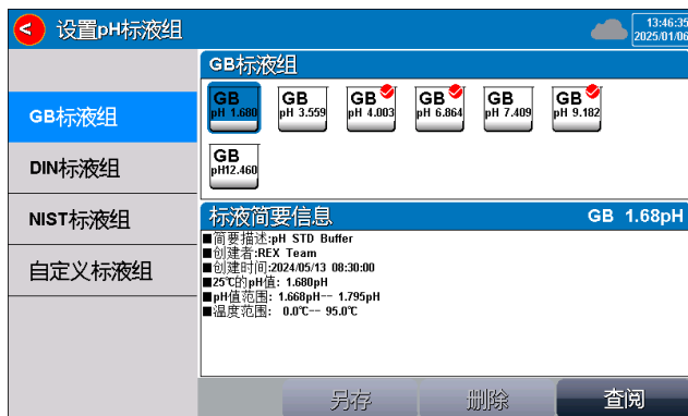
图 4-7 pH 标液组管理显示示意图
