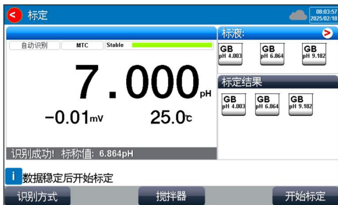
图 7-1 pH 电极标定示意图
