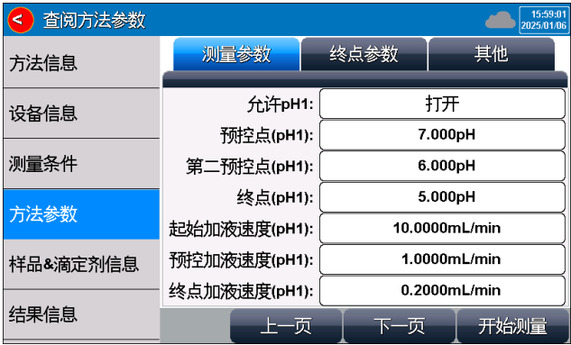
图 5-14 恒 pH 滴定参数显示示意图
