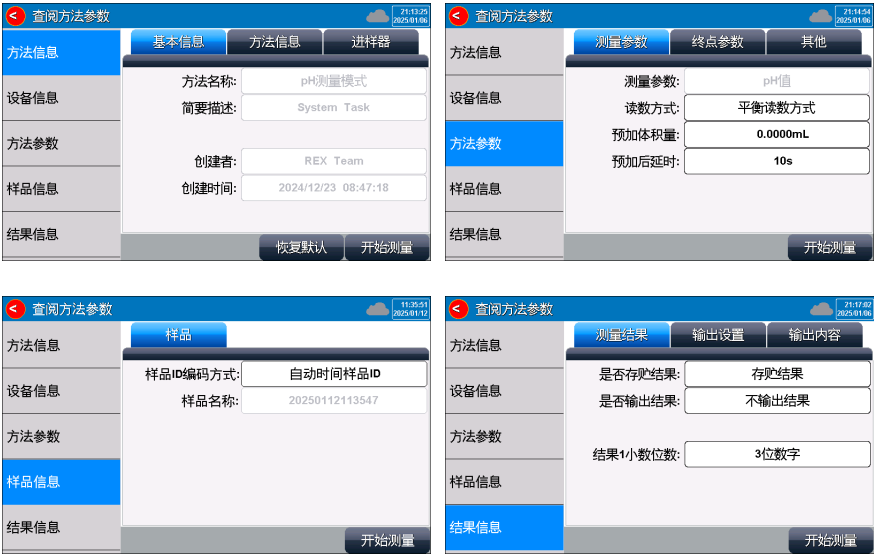
图 7-4 非滴定参数设置显示示意图
