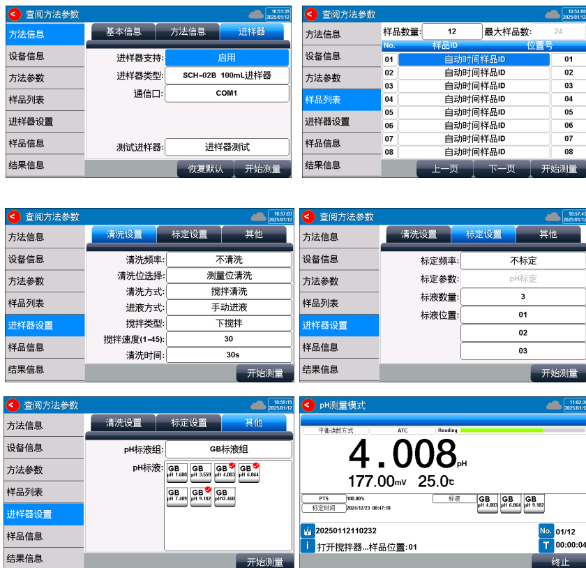
图 7-6 使用进样器测量显示示意图
