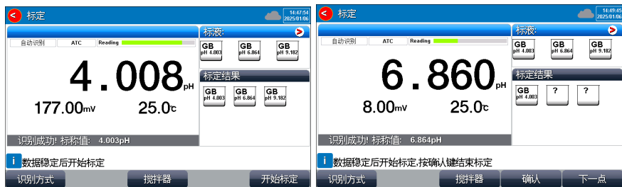
图 4-16 标定 pH 电极示意图
