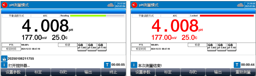
图 7-5 非滴定测量显示示意图
