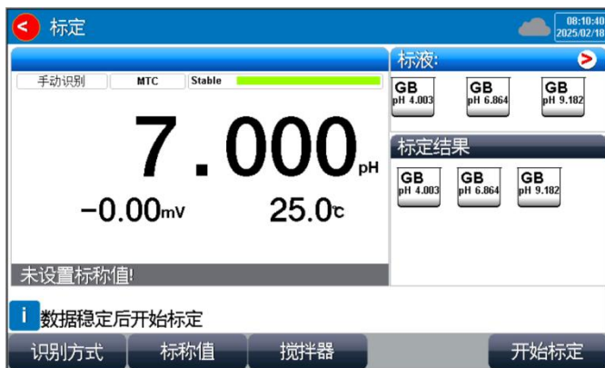
图 7-2 pH 标定手动识别方式示意图
